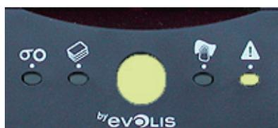
Si no limpia la impresora, el piloto permanece encendido y parpadeará cada vez que inserte 100 tarjetas más. En este caso, detenga inmediatamente las tareas de impresión y limpie la impresora.
